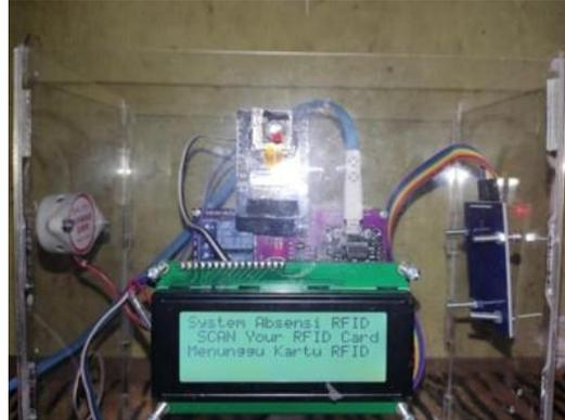
**Gambar 2** Tampilan Box Bagian Depan Alat Presensi
